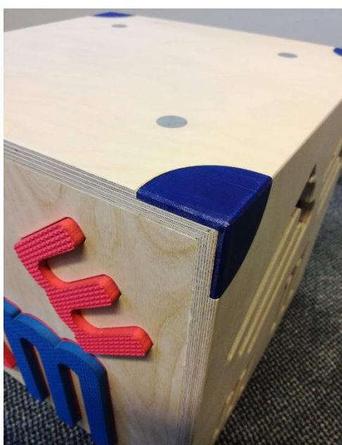
Obr. 8 Označenie: Detail osazení rohové vazby z 3D tisku [archív autora]
