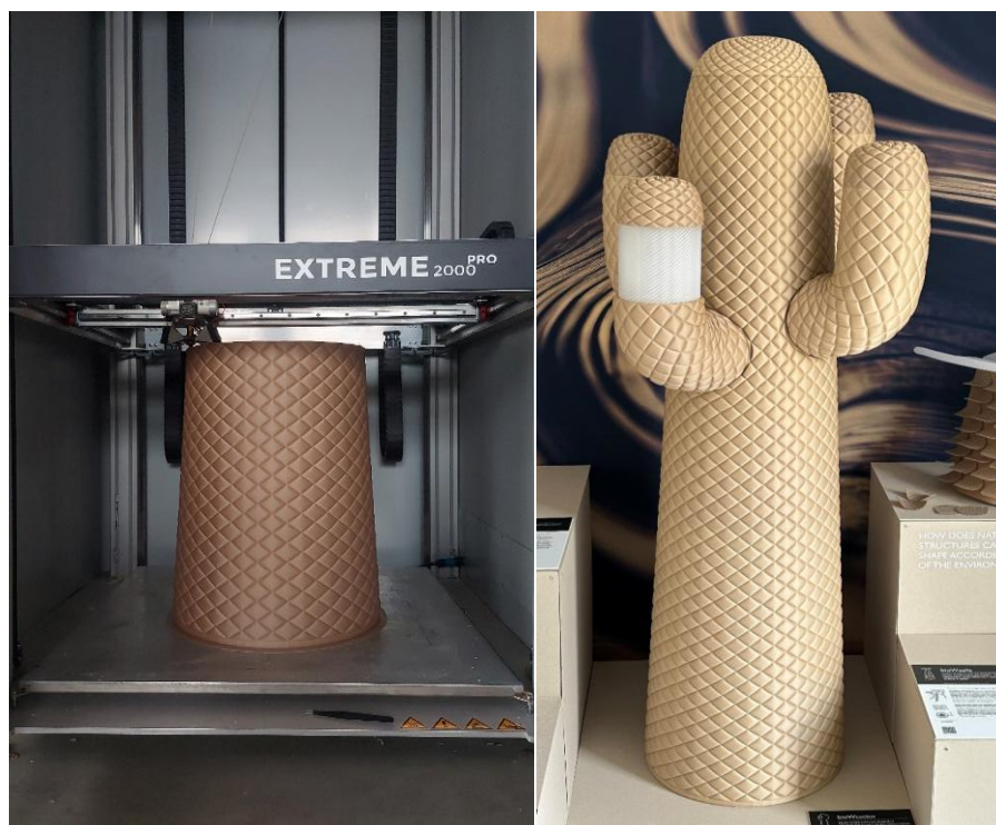
Obr. 3 Priebeh tlače pomocou portálovej LFAM tlačiarne Builder extreme 2000 PRO a produkt bioWcactus [10.]
